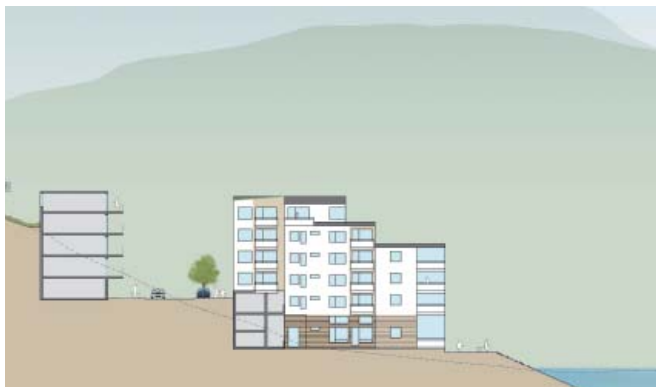
Sektion 5A-5A genom Utsiktsgatan visar Strandhusens placering i den branta terrängen, med entréer på två nivåer, från gård och gata.
