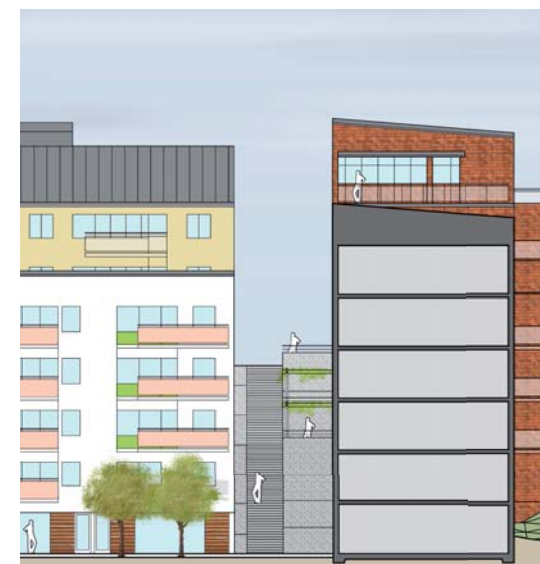
Tvärsektionen 2B-2B ovan är dragen genom Tollare trappgränd mot norr och visar hur byggnadernas fasader ska ligga i liv med stråket för att tydligt definiera detta.
