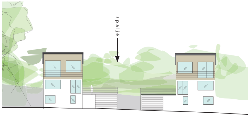
Sektion 6D-6D längs Utsiktsgatan som visar hus med terrasser ovanpå carportarna åtskilda av en spaljë i tomtgräns.
